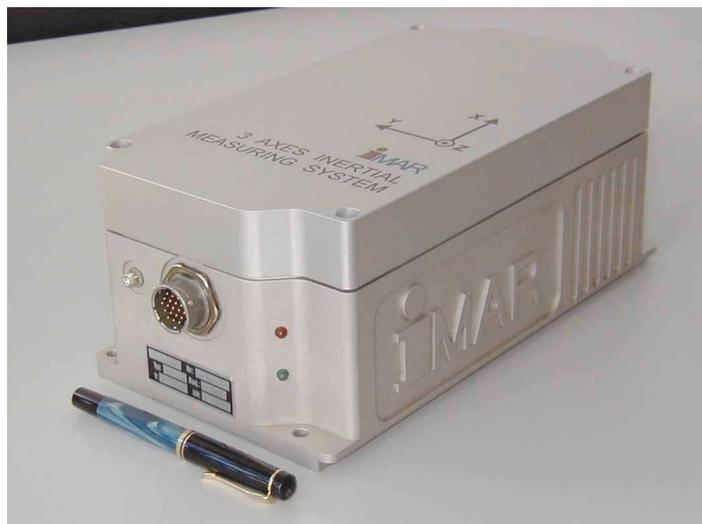
**Bild 3:** iDIS-FMS (Höhe: 108 mm) mit Closed-loop-Faserkreislern in Multiplex-Technologie. Masse: 4.7 kg. P<30 W.
