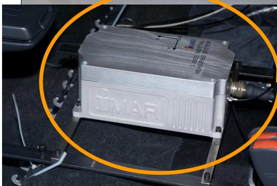
Die Entwicklung von Kraftfahrzeugen ist ohne den Einsatz sog. Kreiselplattformen zur Fahrdynamikanalyse heute kaum mehr vorstellbar. Im folgenden werden die Eigenschaften heutiger inertialer Meßsysteme für den Einsatz in Bewegungsvermessung, Stabilisierung und in der 3D-Topologievermessung dargestellt. Exemplarisch wird die dynamische Vermessung von Kraftfahrzeugen mit der neuesten Generation von iMAR-Kreiselplattformen der iMAR GmbH, St. Ingbert vorgestellt (Stichwort: "Elchtest").
